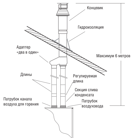
Система дымоудаления - вертикальная с коаксиальными трубами
